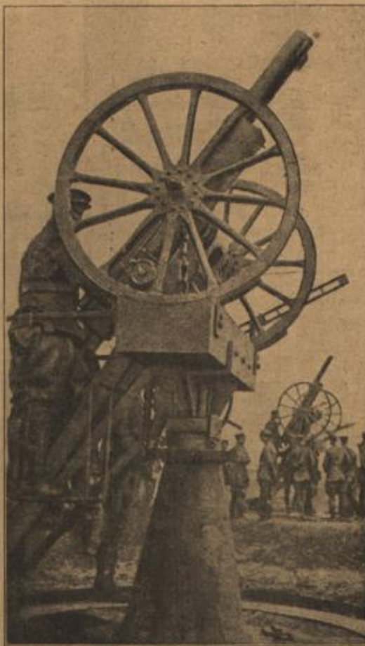
Englisches Flugabwehrgeschütz auf drehbarem Fuß montiert.
