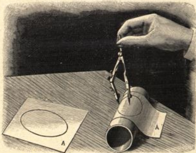
Ein Oval mit einem gewöhnlichen Zirkel in einem einzigen Zuge zu zeichnen.
