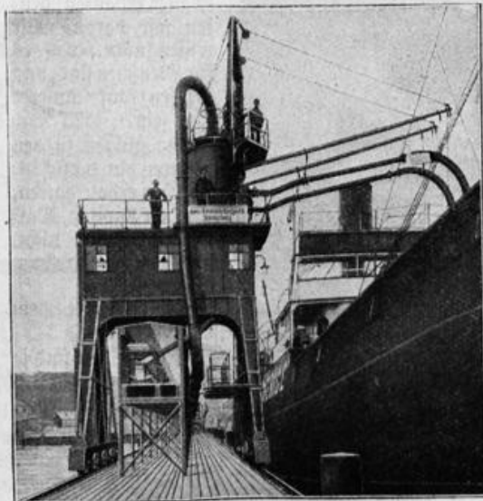
Oben: Saugrüssel einer Luftförderanlage, aus einem Schiffsraum Getreide absaugend
