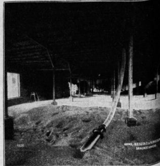
Oben: Saugrüssel einer Luftförderanlage, aus einem Schiffsraum Getreide absaugend
